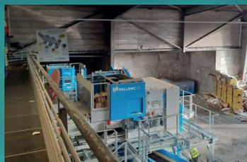
Installation de la machine à courants de Foucault
